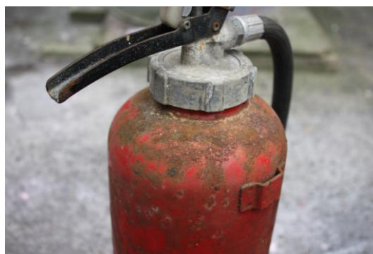
本体上部のあばた状の腐食
